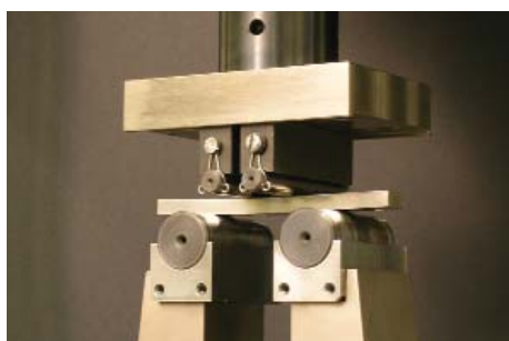
Ermüdungstest an lasergaslegiertem Ti6Al4V
