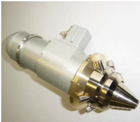
Abb. 1: Modularer Beschichtungskopf, bestehend aus Laseroptik, Justiereinheit und Koaxial-Pulverdüse
