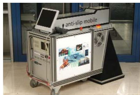
Mobile Anlage zur rutschhemmenden Aus- rüstung von Natursteinen
