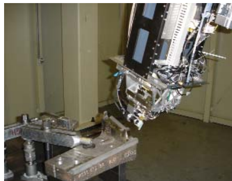
IWS-Verfahrensentwicklung: Laserhärteportal bei BMW Eisenach
