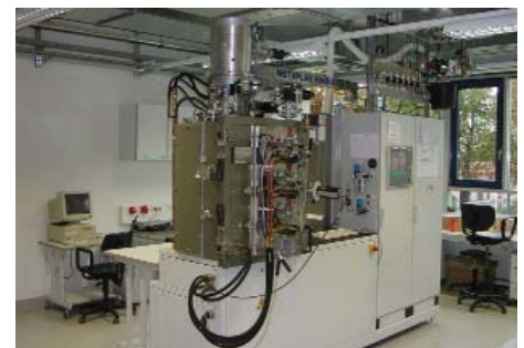
Anlage zur Abscheidung von nitridischen Hartstoffschichten
