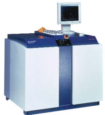
Abb. 3: Einsatz von im IWS hergestellten Multischicht-Monochromatoren in einem RFA-Gerät
