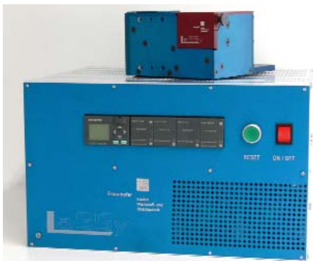
Abb. 2: Scanningsystem für Hochleistungs-diodenlaser
