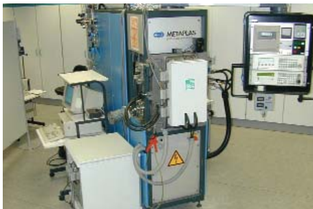
Abb. 2: Arc-Beschichtungsanlage mit Brennflecksteuersystem ProArc
