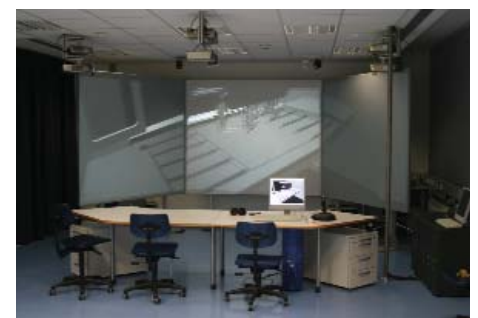
Abb. 3: VR-Installation zur Visualisierung von Anlagen und Prozessen
