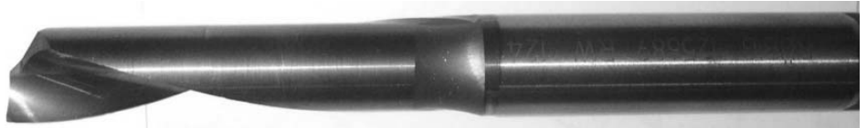
Abb. 1: Einzahn-Hartmetallfräser für das Zirkularfräsen hochfester Aluminium-Legierungen
