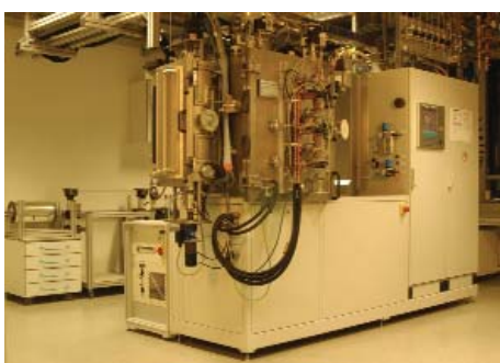
Anlage zur Abscheidung von superharten diamantähnlichen Kohlenstoffschichten (Diamor®) nach dem Laser-Arc-Verfahren
