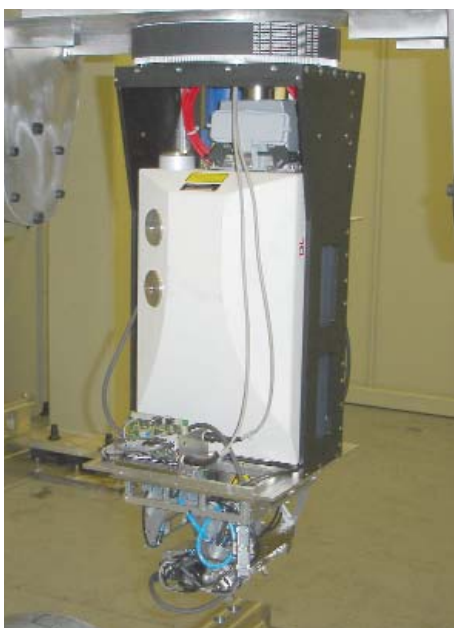
Abb. 2: Zweites Lasermodul, integriert in Laserhärteportal
