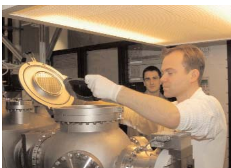
Substratbestückung an einer UHV-Präzisionsbeschichtungsanlage zur Herstellung von nm-Multischichten
