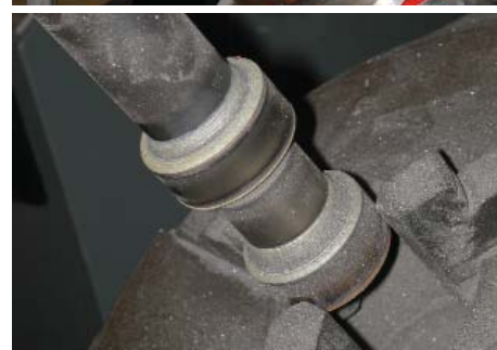
Abb. 2: Bauteilbeschichtung am Roboter
