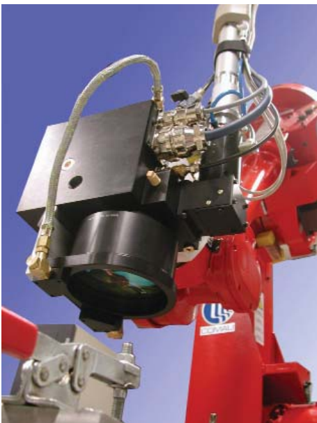
Abb. 1: Strahlablenkoptik lasertronic® SAO1.06 für das Remote-Schweißen mit Hochleistungs-YAG-Lasern
