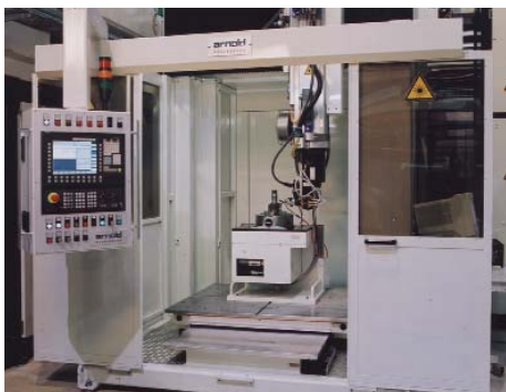
Laserstrahlschweißanlage mit 6 kW-CO 2 -Hochleistungslaser
