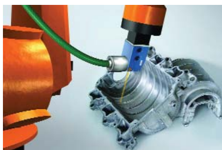
Klebflächenvorbehandlung eines Ansaugmoduls aus Magnesiumdruckguss mit Nd:YAG-Laser
