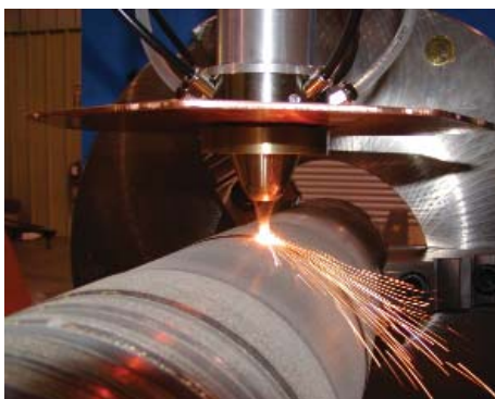
Abb. 3: Koaxial-Pulverdüse zum Panzern von Ölbohrwerkzeugen
