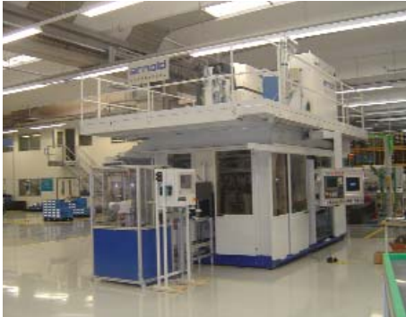
Anlage für ein vom IWS entwickeltes Laserschweißverfahren mit Zusatzwerkstoff bei ZF Gotha (Systemintegrator Arnold)
