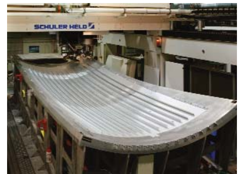
Abb. 2: Beidseitig-gleichzeitiges Schweißen von Stringer-Hautfeldverbindungen
