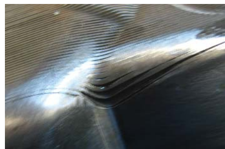
Abb. 2: MELATO®-Doppelstempel nach dem partiellen Verschleifen der Stufen
