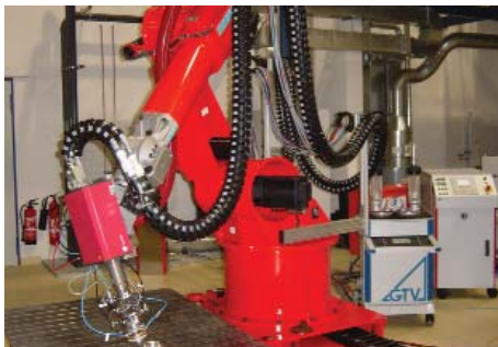
Abb. 2: Universelles Robotersystem zum Laserstrahl-Auftragschweißen
